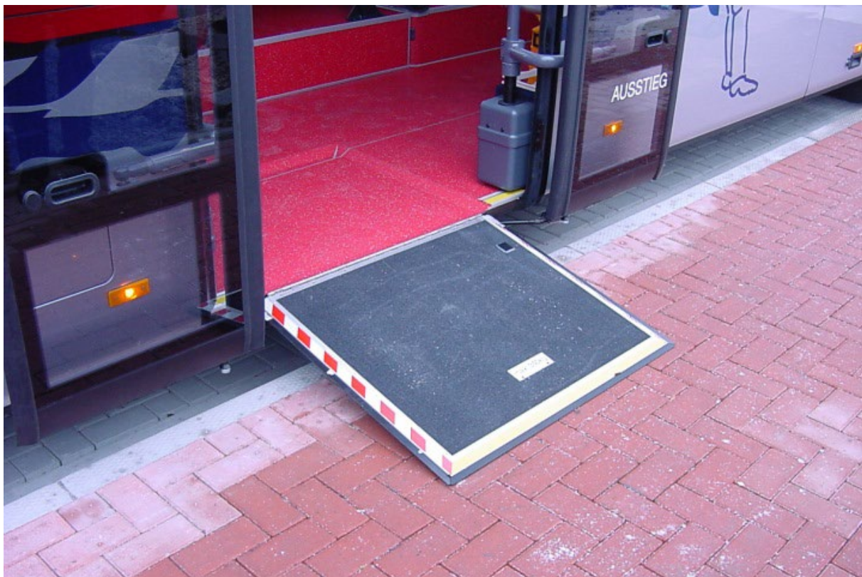
Abbildung A - 5: Rampe zur Verbesserung eines barrierefreien Ein- und Ausstiegs
